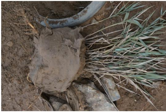
图4 穿越虚拟大孔径植生布生长的芦苇地下部分
