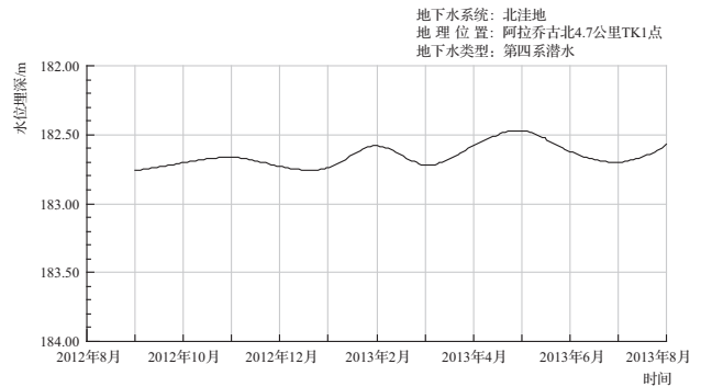
图 2 北洼地地下水水位动态变化曲线
