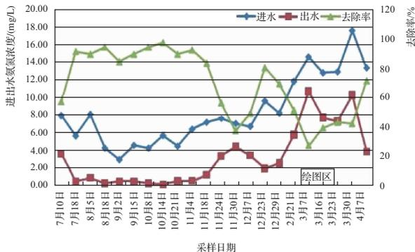
图4 两级湿地对NH<sub>4</sub><sup>+</sup>-N的去除效果
